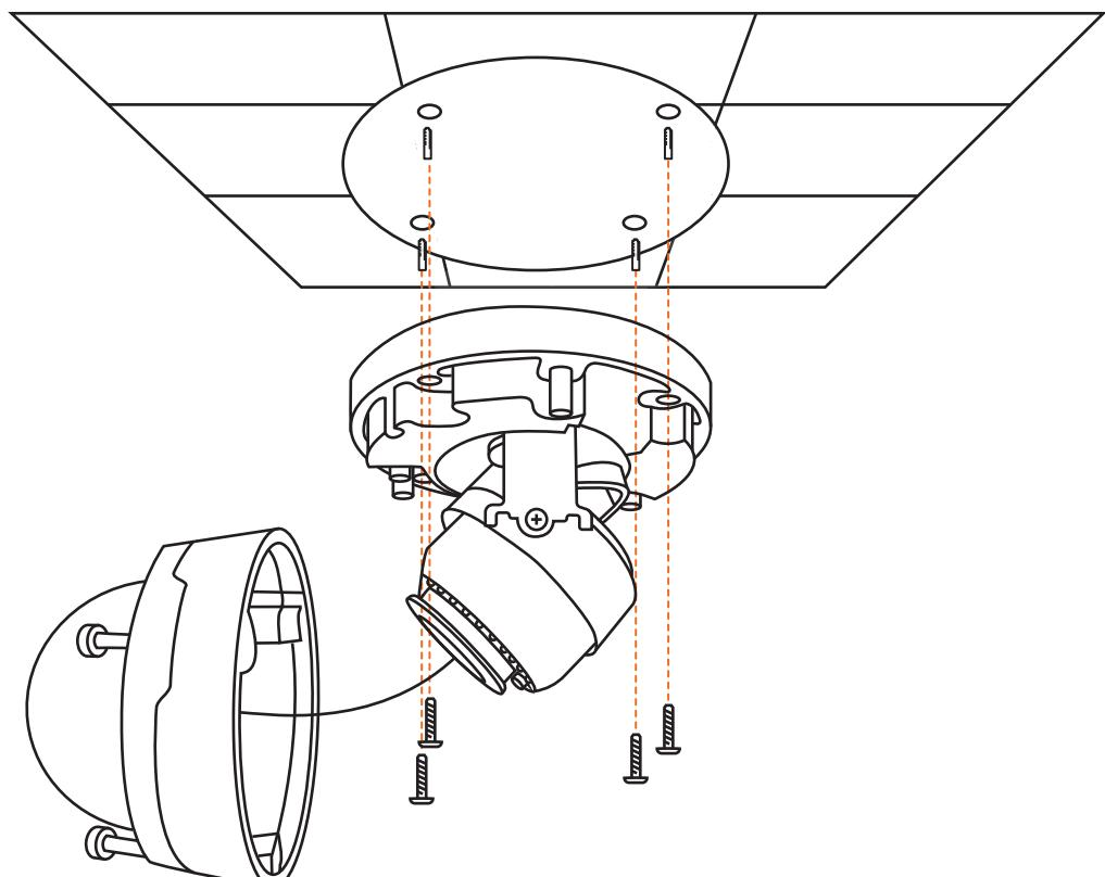
5. Stel de positie van de camera in. Draai de stelschroef iets losser om de camera in hoogte te verstellen.
