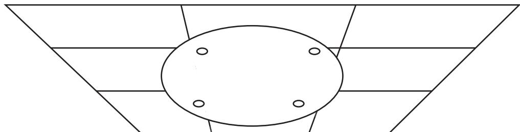
4. Die Löcher bohren und die Kamera befestigen. (für die Schraubenlöcher benötigen Sie einen 6-mm-Bohrer, für die Kabeldurchführung einen 20-mm-Bohrer).
