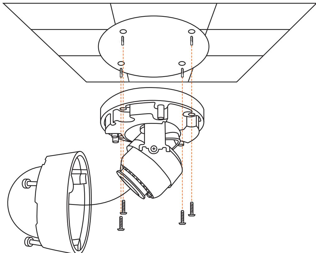
5. Die Kameraposition durch Drehen einstellen. Zur Änderung der Kamerahöhe die Stellschraube leicht lösen.
