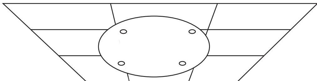
4. Percez les trous et fixez la caméra. (Utilisez une mèche de 6 mm pour les trous de vis et une mèche de 20 mm pour le passage de câble).
