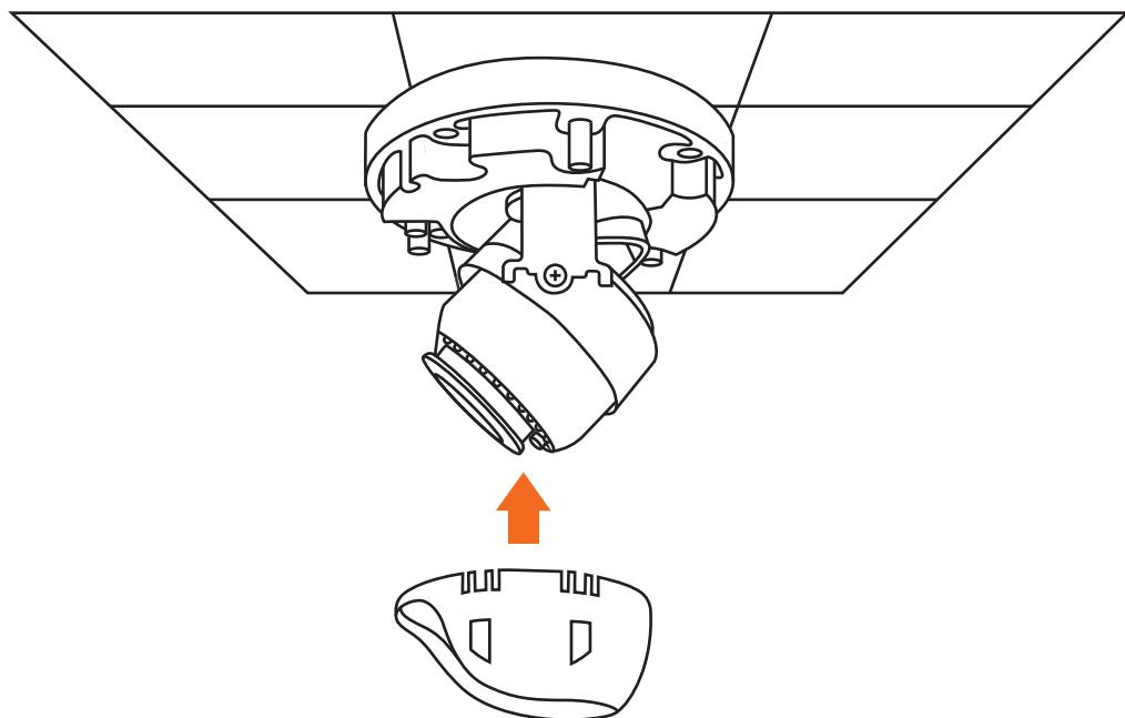
9. Plaats de dome beschermkap terug en draai de drie schroeven vast.
