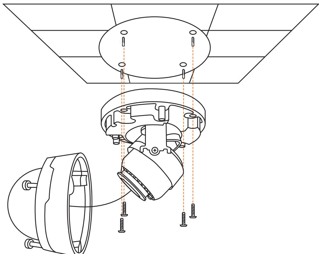
5. Réglez la position de la caméra. Desserrez légèrement la vis de réglage pour régler la hauteur de la caméra.
