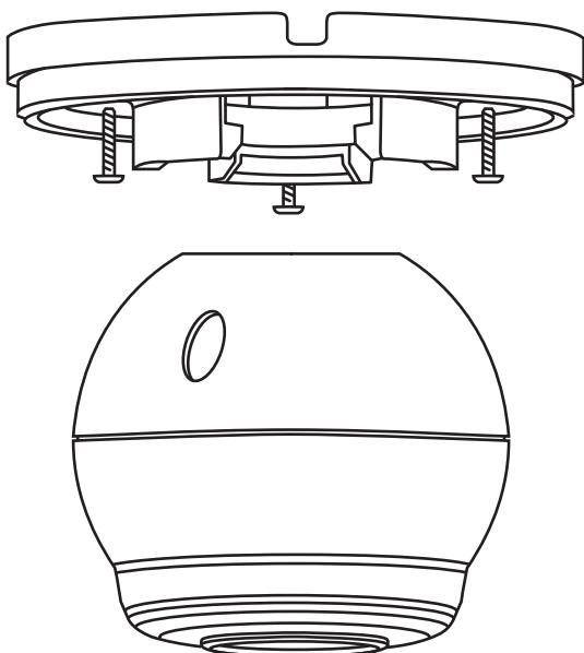
5. Ajuster l'angle de la caméra et installer le collier.
