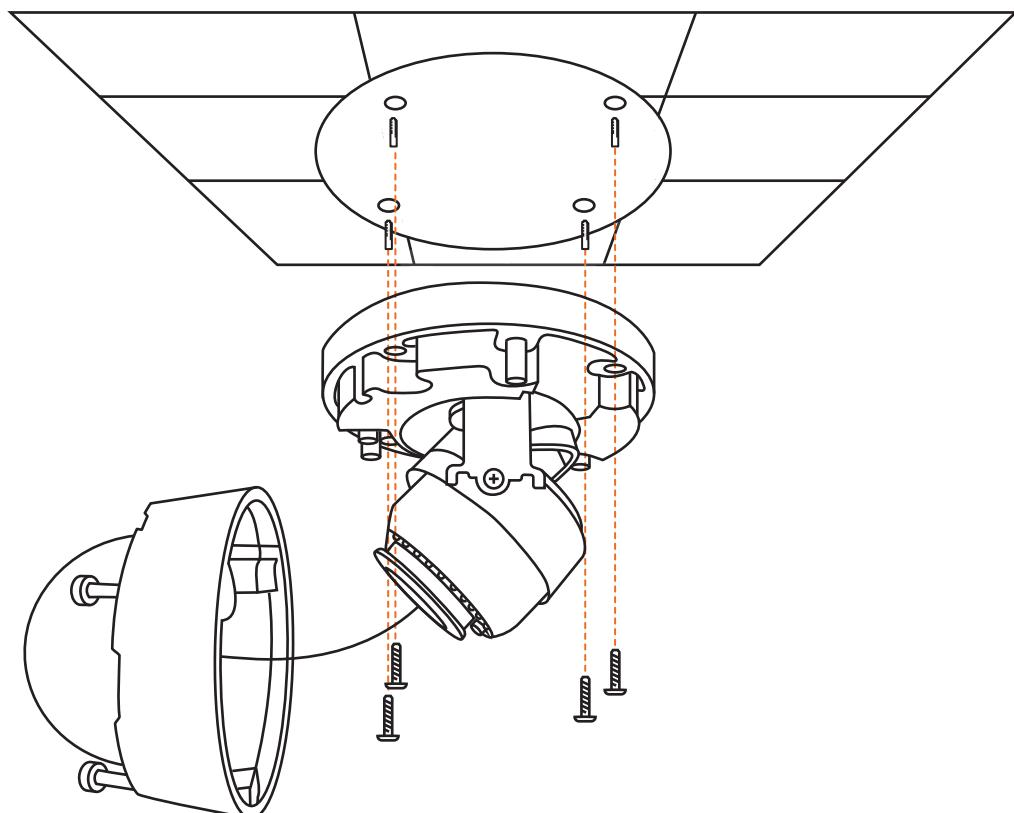
5. Stel de positie van de camera in. Draai de stelschroef iets losser om de camera in hoogte te verstellen.
