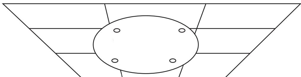
4. Boor de gaten en zet de camera vast. (Gebruik een 6mm boor voor de schroefgaten en een 20mm boor voor kabeldoorgang).
