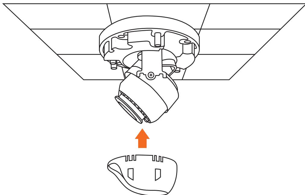
9. Remettez le capot de protection dôme en place et fixez les trois vis.
