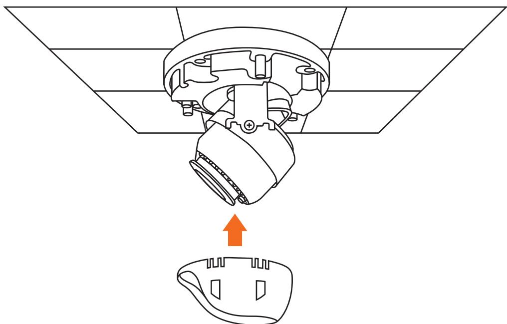
9. Die obere Schutzkappe zurücksetzen und die drei Schrauben festdrehen.
